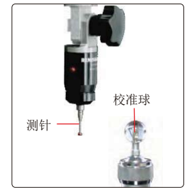
探针(选配), 包含 \varnothing 2mm和 \varnothing 3mm测针, \varnothing 25mm校准球, 测量精度10 \mu m
